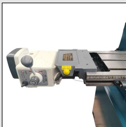
Mesa de 1000x240mm con avance automático
