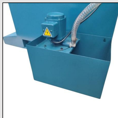
Equipo de refrigeración
